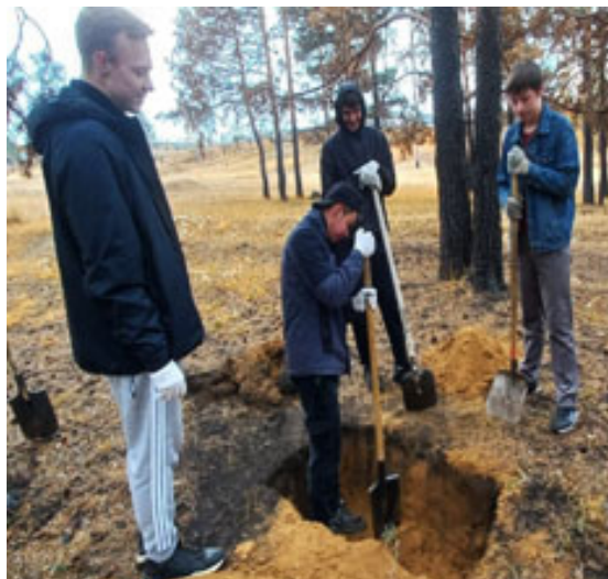
Рис. 1 Отбор проб почвы методом конверта и из почвенного разреза (Технология выполнения работ по профессии рабочих «Пробоотборщик»)
