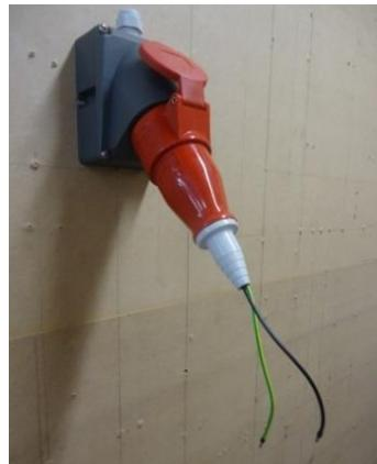
Подготовленные разъёмы соединяются с соответствующими разъёмами ЭУ. К полученным проводникам подключаются электроды мегомметра.
